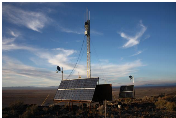
図 3.8 Black Rock Mesa の通信塔。サイト内に設置されている 3 基の通信塔のうちの 1 基。写真上部のボックスにタワーエレクトロニクスが取り付けられている。タワーエレクトロニクスが SD と通信を行うために使用しているアンテナは方位角に対して無指向性のコリニアアンテナ (COMET 社製 GP-D2422-3) を使用している。タワー PC はソーラーパネル裏のボックスの中に設置されタワーエレクトロニクスと TCP/IP と一部シリアルケーブルを用いて通信を行う。通信塔にあるタワーエレクトロニクスが SD と交信し空気シャワーイベントを取得する。通信塔は通信塔同士、あるいは FD ステーションやデルタ市と無線 LAN 通信を行いテレスコープアレイ実験全体のネットワークを構築している。
