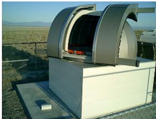
図 3.22 LIDAR ドームの概 観。観測時にドームが開き 1Hz でレーザーを打ち大気 の状態を測定する。
