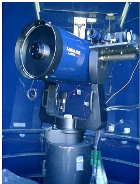
図 3.21 LIDAR システム。 中央の反射型望遠鏡が後方 散乱光を中央に設置してある PMT に集光する。
