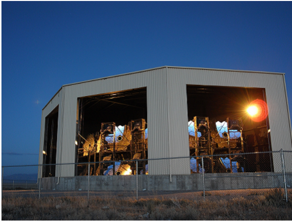
図 3.14 BRM,LR 型の FD ステーション。観測期間外では PMT カメラ保護のためシャッターが閉められている。1 ステーションに上下 2 段 6 セットの 12 台の望遠鏡システムが構築されている。
