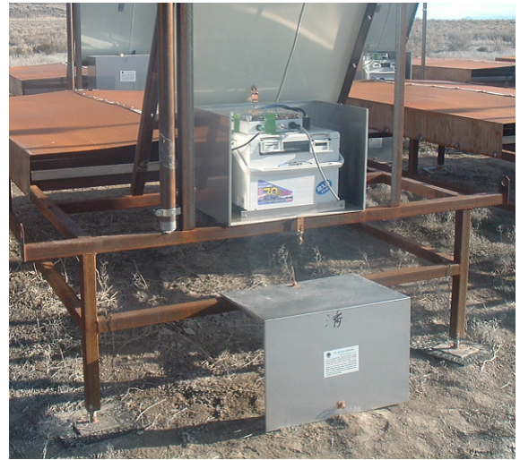
図 3.5 ソーラーパネルの下の箱にはエレクトロニクスとバッテリーが格納されている。L字型の上蓋を開けた状態。
