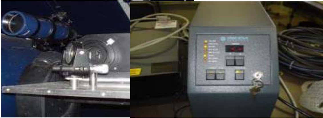
図 5.4 左図はレーザーのヘッド部分、右図はレーザーの電源・制御部である。
