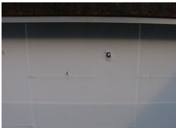
図 2 - 4 パネル裏面の破損 1 (ND-L3EJE)
