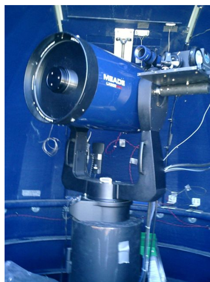
図 4.39 LIDAR ドーム内部の様子。反射方望遠鏡 (中央) と YAG レーザー (右上) によって構成される。
