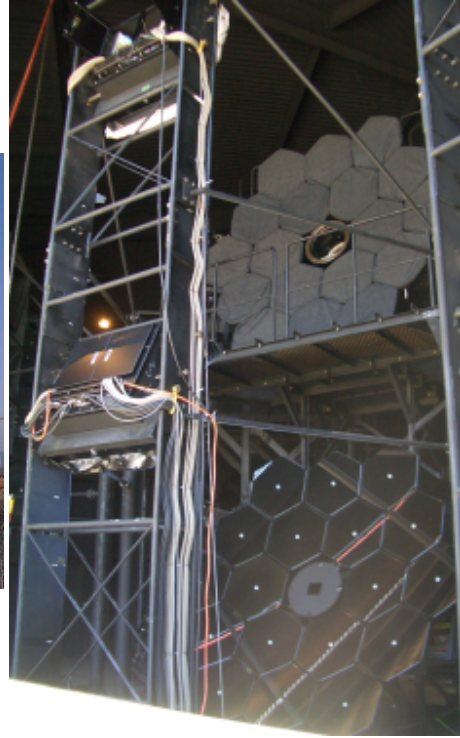
図 4.33 FD ステーション内に設置されている FD。球面鏡 (右側)、PMT カメラ (左側) が上下 2 段で設置されている。
