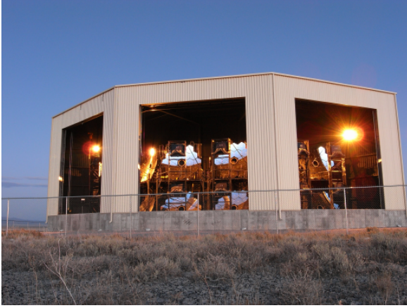
図 4.32 FD ステーションの外観。通常観測時間外では PMT 保護の為シャッターを閉めている。
