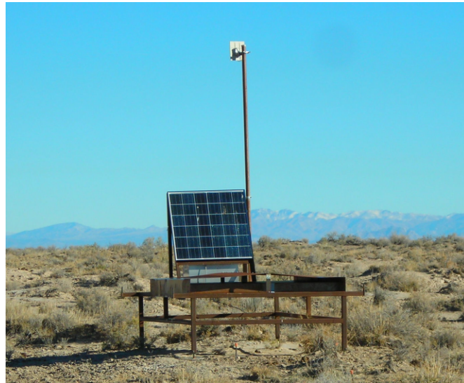
図 4.3 実験サイトに設置した地表粒子検出器
