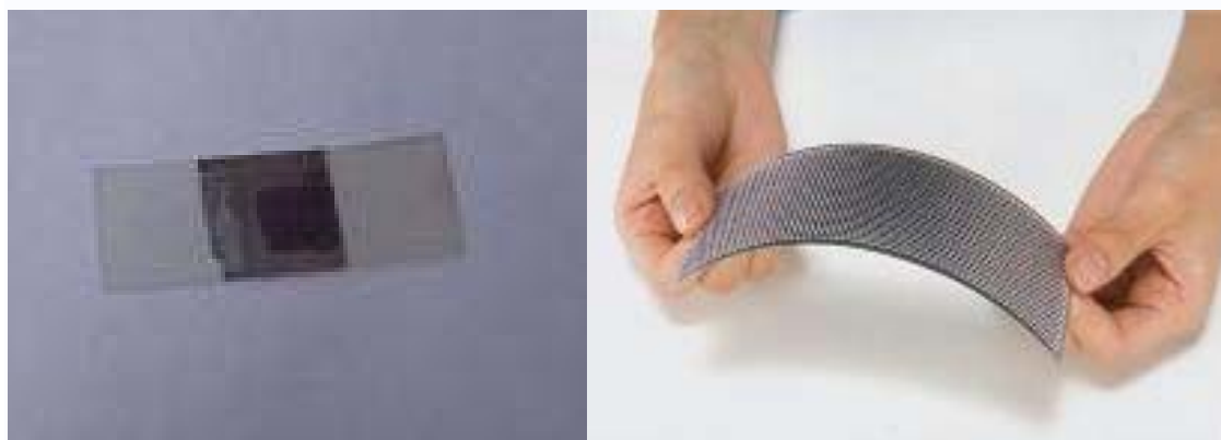
図 3-2-3 (左) 色素増感太陽電池と(右) 球状シリコン型太陽電池
