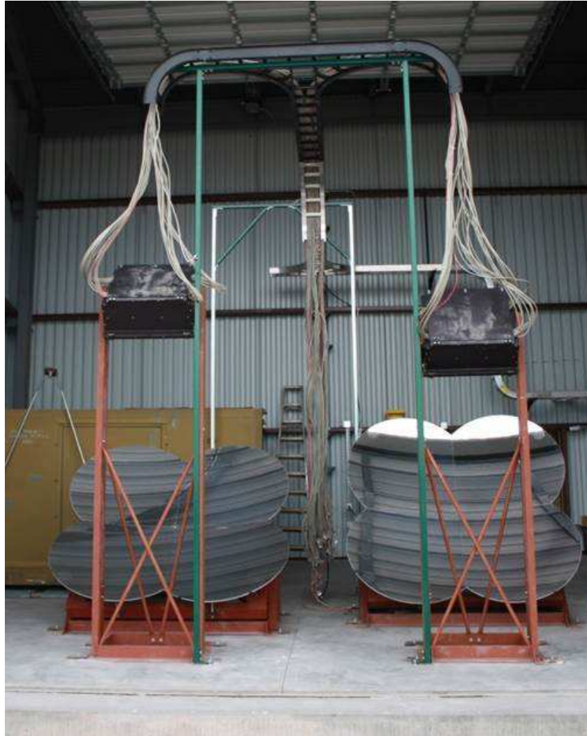
図 2.16: TALE ステーションの大気蛍光望遠鏡.
