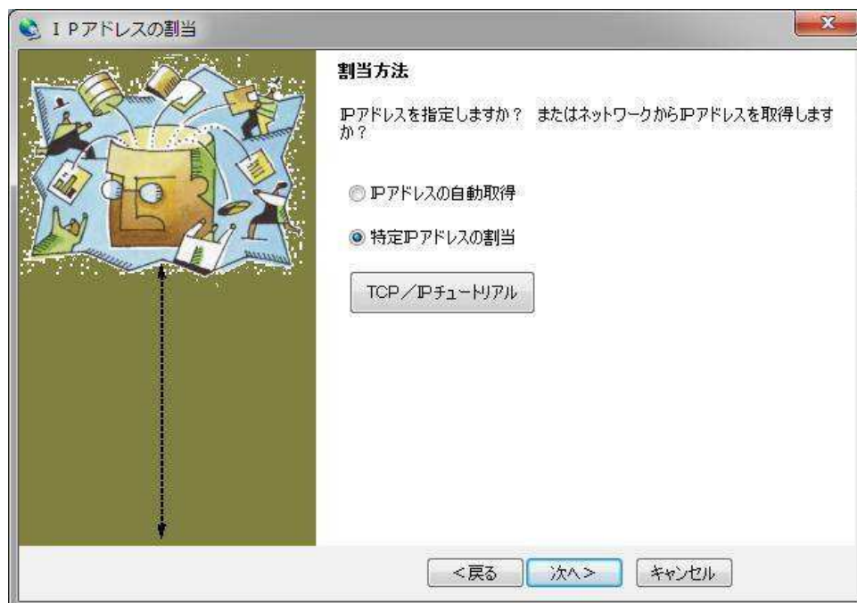
図 6.6: XPORT の IP アドレスの割当方法の選択画面。
