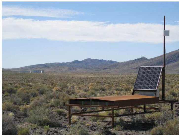
図 2.5: 現地に設置された TALE-SD. 左奥に MD/TALE-FD ステーションが見える。
