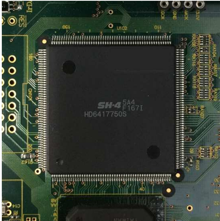
図 3.2: TA 実験用 SD で使用されている CPU. ルネサステクノロジ社製 SH4 マイコン SH7750S.
