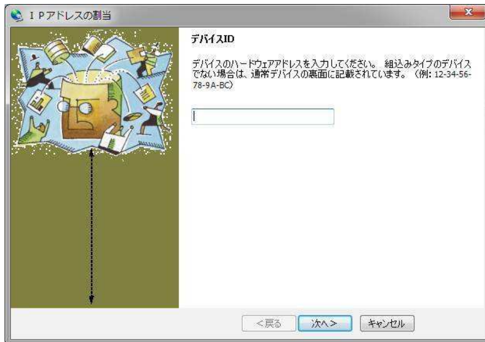
図 6.5: XPORT の IP 割当のための XPORT ハードウェアアドレスの入力画面。
