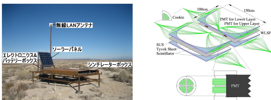
図 3.2: TA 地表検出器。左は現地に設置した検出器の写真、右はシンチレータ等の設置図である。
