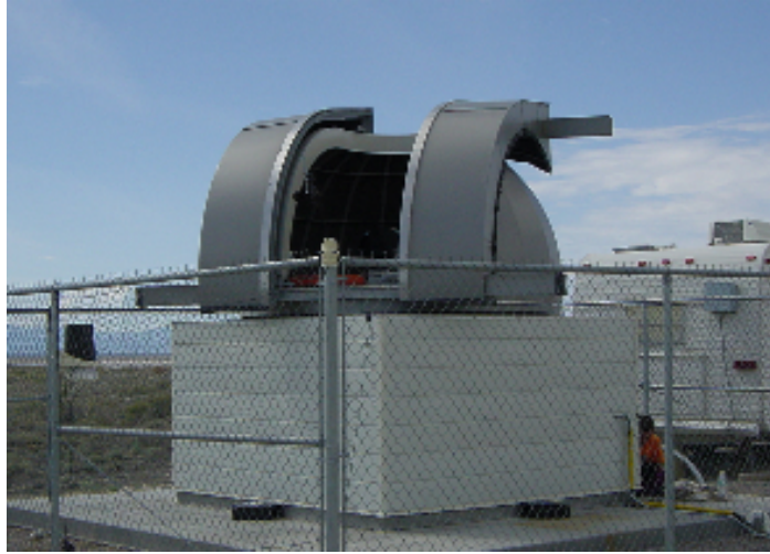
図 4.2 LIDAR ドームの概観
