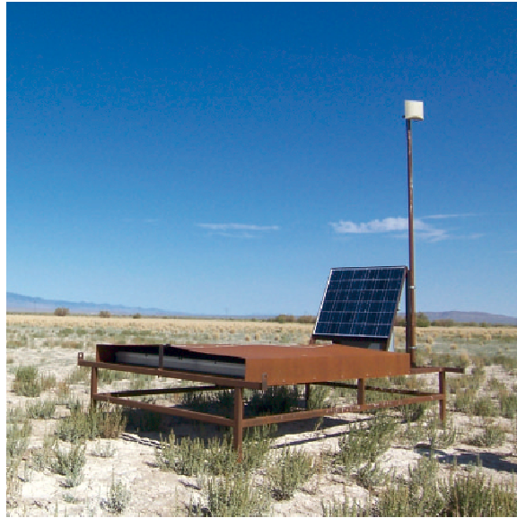
図 3.2: 現地 (ユタ州) に設置された地表検出器
